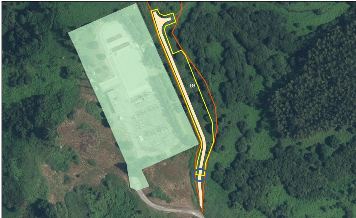
Figura 7.- Vial perimetral en la planta de almacenamiento de energía BESS LAJARA (beige), vallado perimetral (amarillo), límite de la parcela (rojo) y ST La Jara (verde). Acceso a la instalación (círculo azul).
